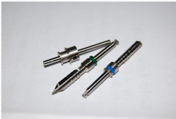
Rys. 4. Opracowane zestawy N1 dla wiertel (Alpa-Bio) 2 i 2,8mm oraz, zestaw N2 dla wiertel (Alpa-Bio) 3,2 i 3,65 mm.
