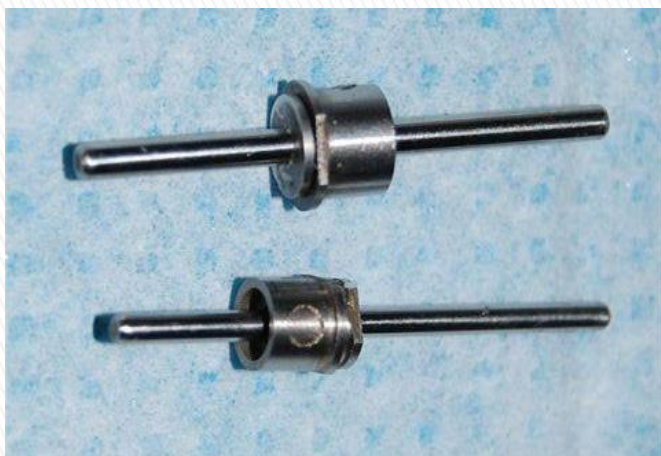
Rys. 4. Opracowane zestawy N1 dla wiertel (Alpa-Bio) 2 i 2,8mm oraz, zestaw N2 dla wiertel (Alpa-Bio) 3,2 i 3,65 mm.
