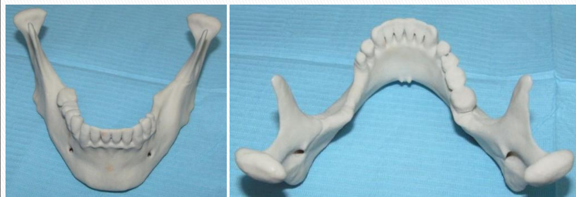
Rys. 12. Model żuchwy wykonany techniką 3DP – (proszek ZP130+ infiltrator żywiczny), model utwardzony specjalną żywicą posiada fakturę powierzchni bardzo podobną do kości naturalnej.
