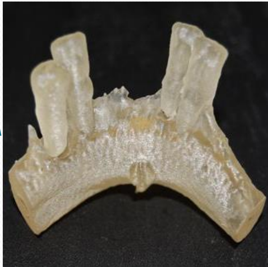
Rys. 18. Wykonanie modelu medycznego metodą PolyJet
