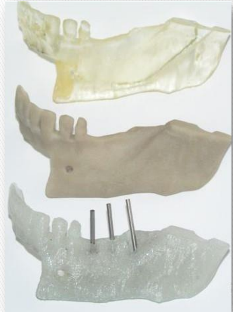
Rys. 8. Model wycinka żuchwy wykonany wybranymi technikami RP: - kolejno: SL, 3DP, FDM.
