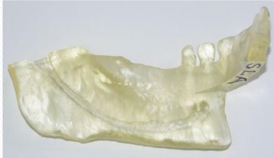
Rys. 9. Model wycinka żuchwy wykonany w technologii SL. (Bardzo dobra widoczność cech budowy wewnętrznej oraz struktury kości, możliwość nawiercania modelu w celu symulacji zabiegu. Temperatura nawiercania nie może przekraczać 45 stopni C.)
