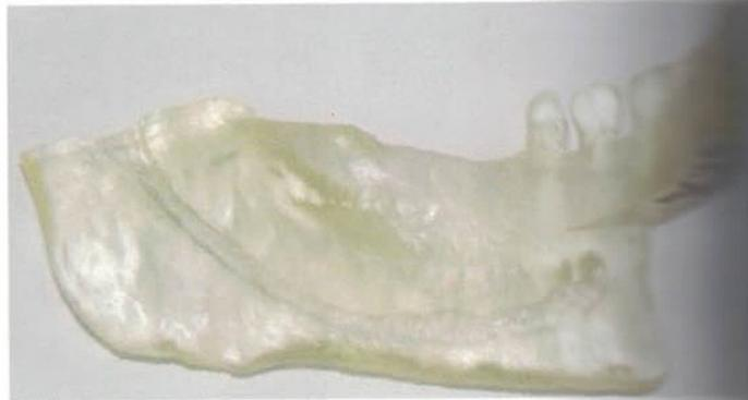
**Мал. 6.** Модель фрагмента нижньої щелепи, виготовленої методом SL (Дуже добра видимість внутрішніх анатомічних структур щелепи уможливорює симуляцію процедури імплантації, але температура механічної обробки не повинна перевищувати 45°C)
