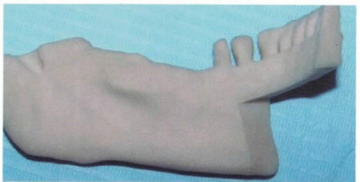
Мал. 8. Фрагмент моделі нижньої щелепи того ж пацієнта, виготовленої методом 3DP (порошок ZP130, модель оброблена восковим інфільтратом).
