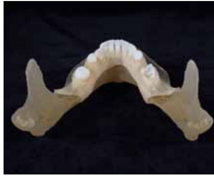
Мал. 4. Багатооб'єктна модель нижньої щелепи, виготовлена технікою PolyJet Matrix
