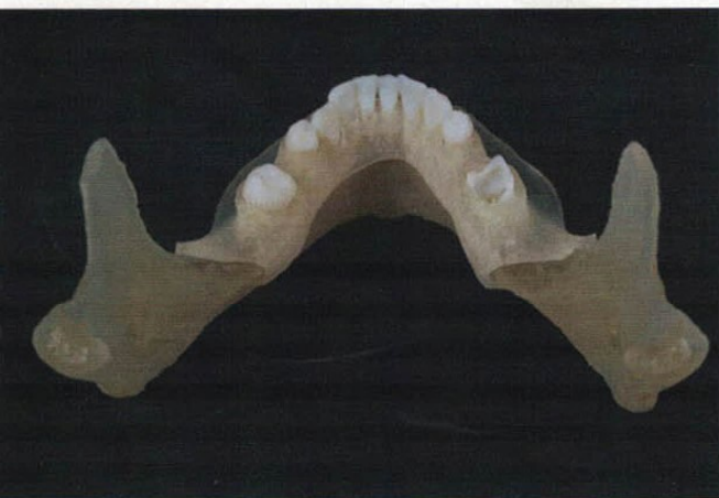
Ryc. 4. Wieloobiektowy model żuchwy wykonany techniką PolyJet Matrix.
